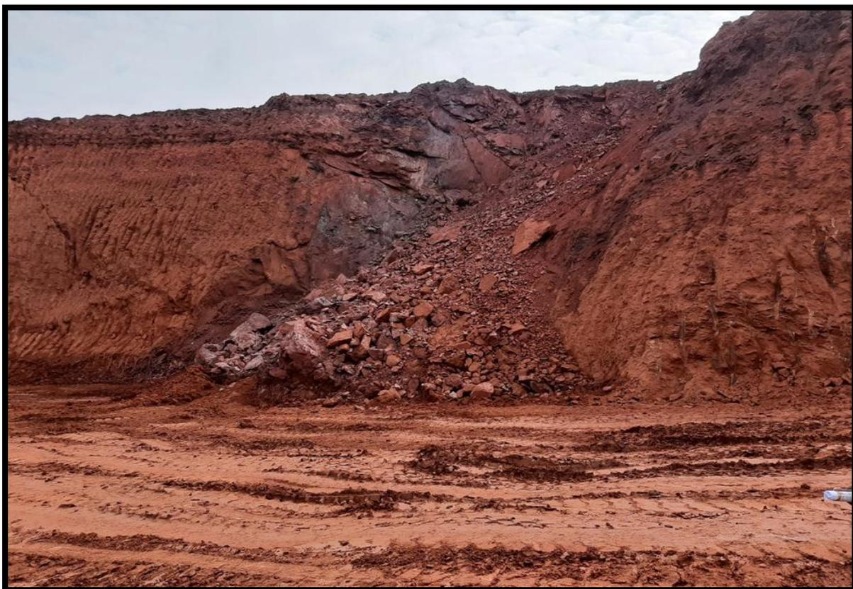
Figura (2) – Rompimento de taludes nas rochas vulcânicas sedimentares.
