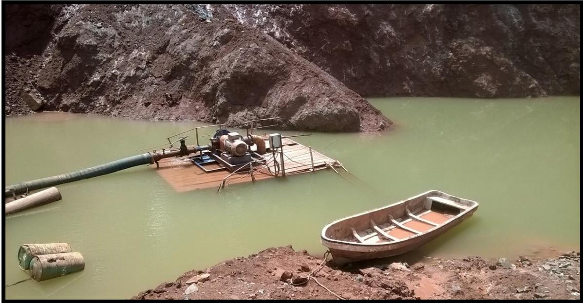
Figura (3.11) – Drenagem das águas no interior da mina de camatchia.
